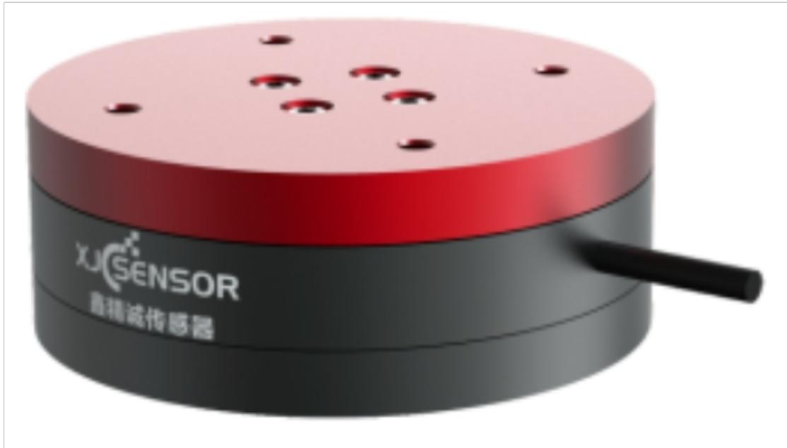
拉压力传感器怎么使用：在水平调整方面。如果使用的是单只拉力传感器的话，其底座的安装平面要使用水平仪调整直到水平；如果是多个传感器同时测量的情况，那么它们底座的安装面要尽量保持在一个水平面上，这样做的目的主要是为了保证每个传感器所承受的力量基本一致。传感器的底座安装面应尽可能的平整和清洁，没有任何油污或者胶膜等存在。安装底座本身应具备足够的强度和刚性，通常要求高于传感器本身的强度和刚度。传感器外壳、保护盖板、引线接头均经密封处理，不准打开。
